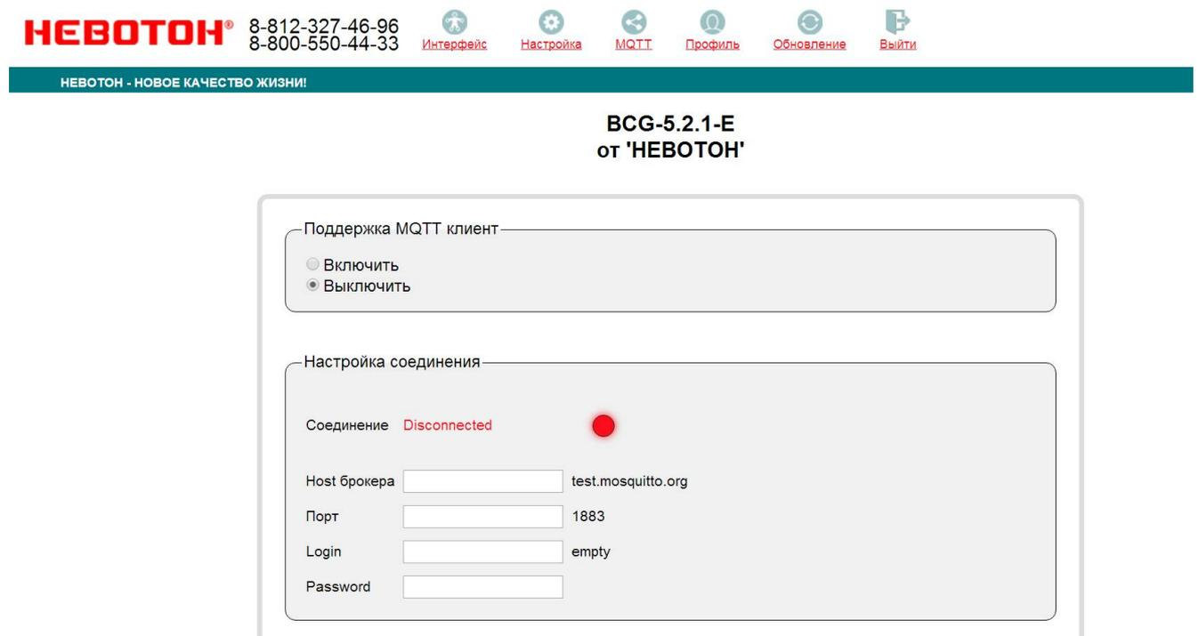
Рисунок 11 – Настройка соединения для MQTT-клиента
